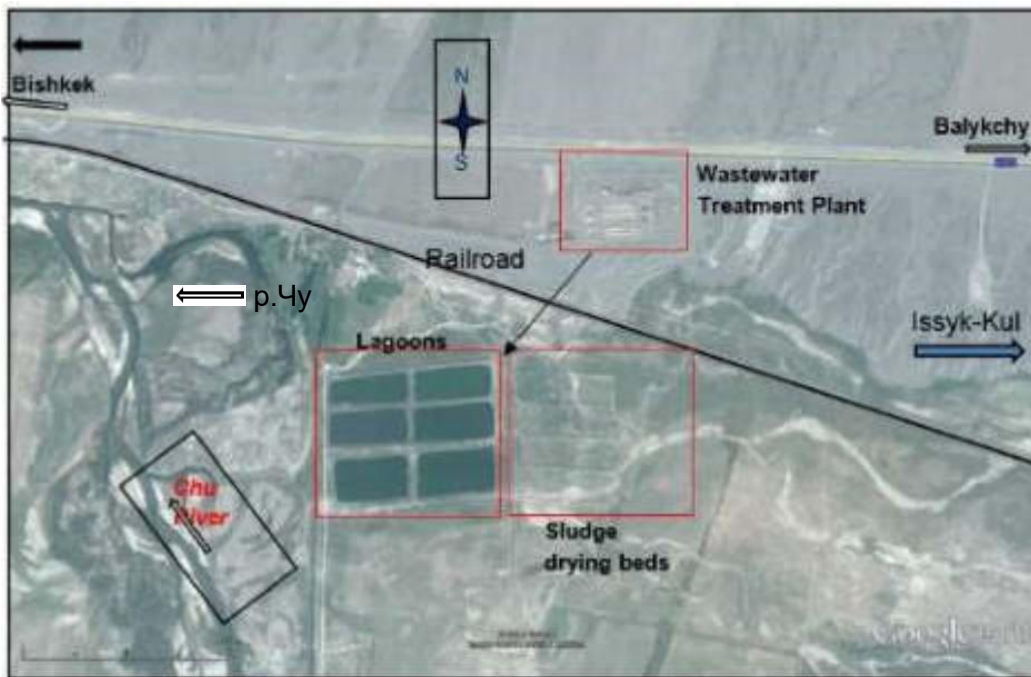
8 Рисунок Существующие очистные сооружения и биологические пруды г. Балыкчы Источник: (ПЭО, 2018)
