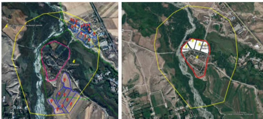
10 Рисунок Санитарно-защитная зона очистных сооружений г. Каракол
