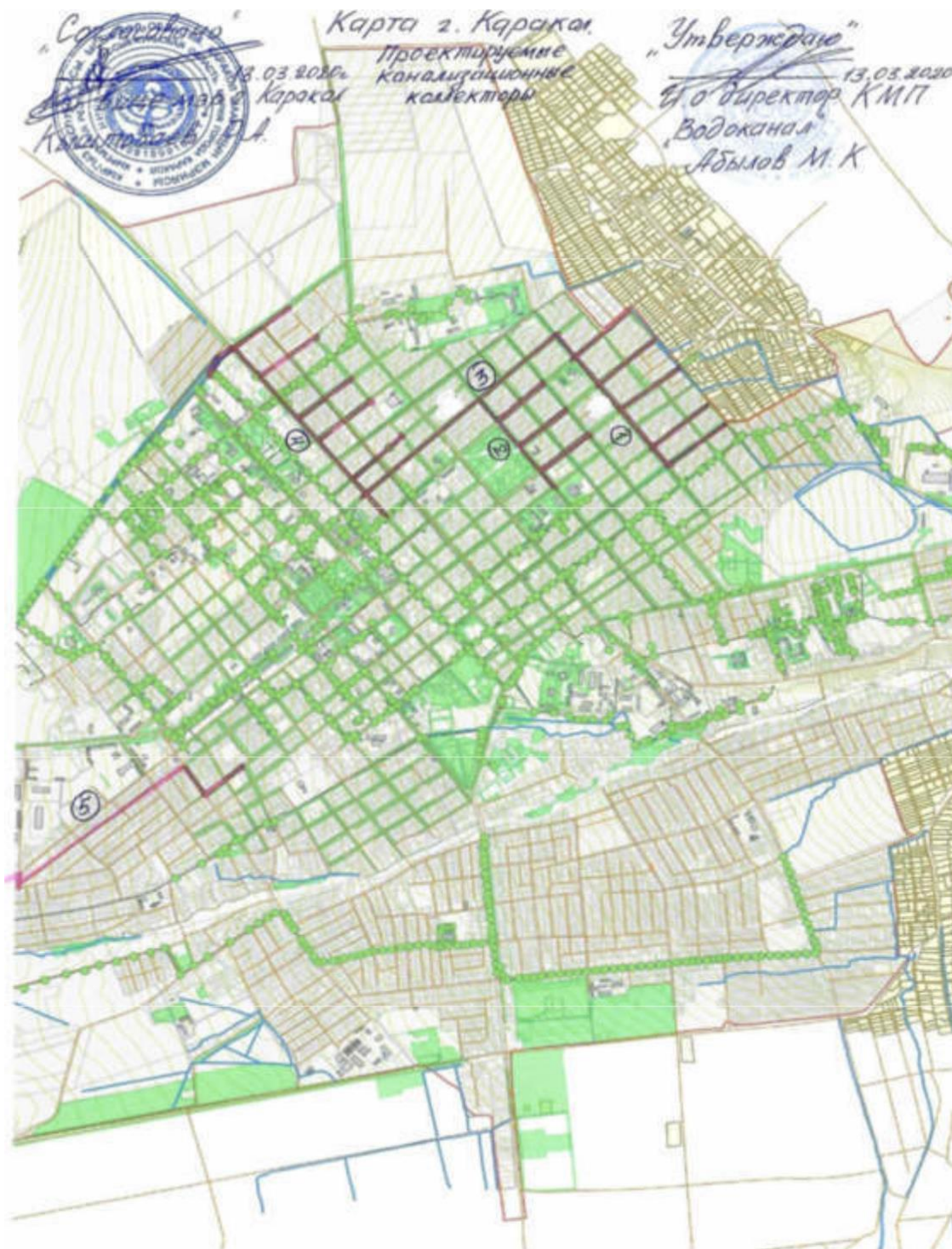
3 Рисунок Новые проектируемые канализационные линии канализационной сети г. Каракол
