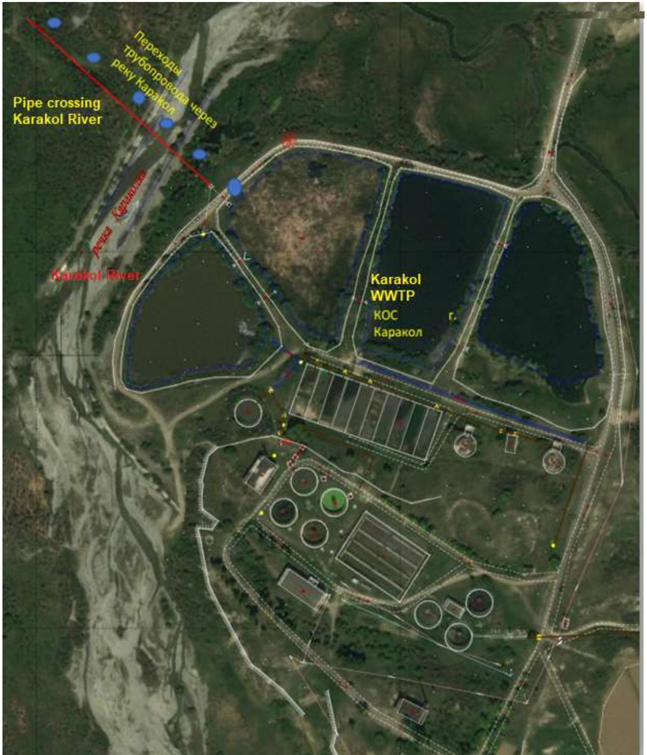
Рисунок 3-9: Пересечение сбросной трубы с рекой Каракол в оросительный пруд
