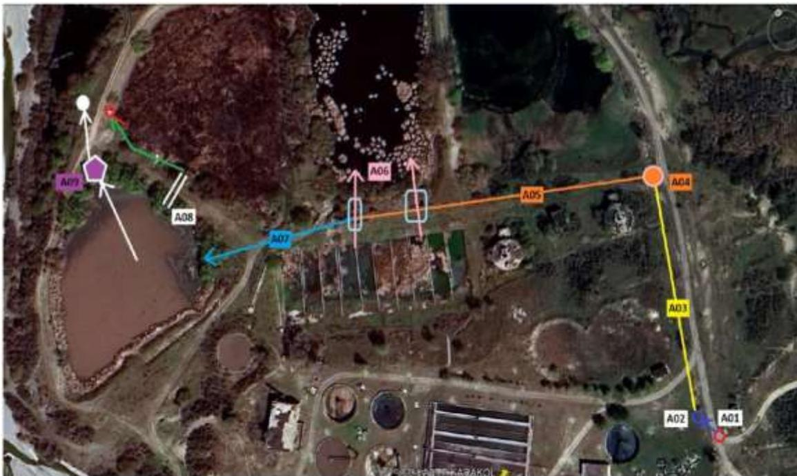
**Рисунок 8: Временная обводная линия во время строительства очистных сооружений.**
