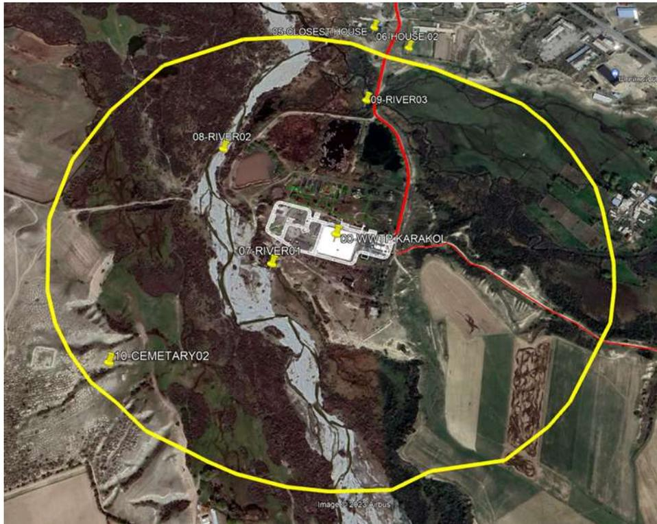
**Рисунок 3. Карта-схема: Санитарно-защитная зона очистных сооружений – 400 метров. (Желтый контур — граница С33 КОС. Размер С33 составляет 400 метров от границы КОС)**
