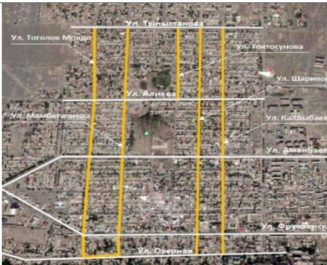
**Рисунок 4: Схема расположения сетей городской канализации в Балыкчы**
