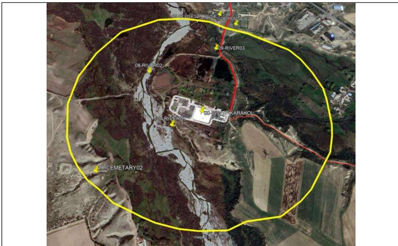
**Рисунок 4-3: Санитарно-защитная зона очистных сооружений 400 метров (Желтый контур - граница С33 КОС. Размер С33 составляет 400 метров от границы КОС)**
