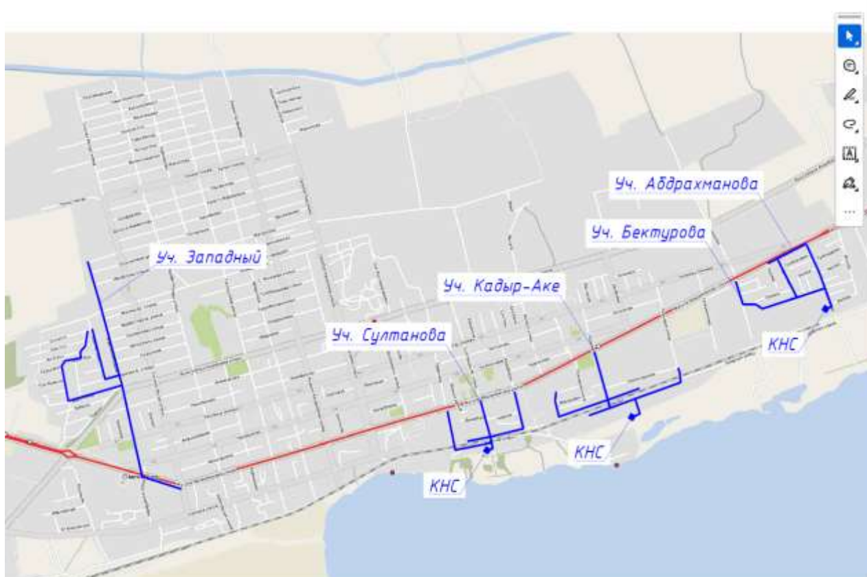
Рисунок 1. Ситуационная схема участков проектируемых канализационных сетей г. Балыкчы
